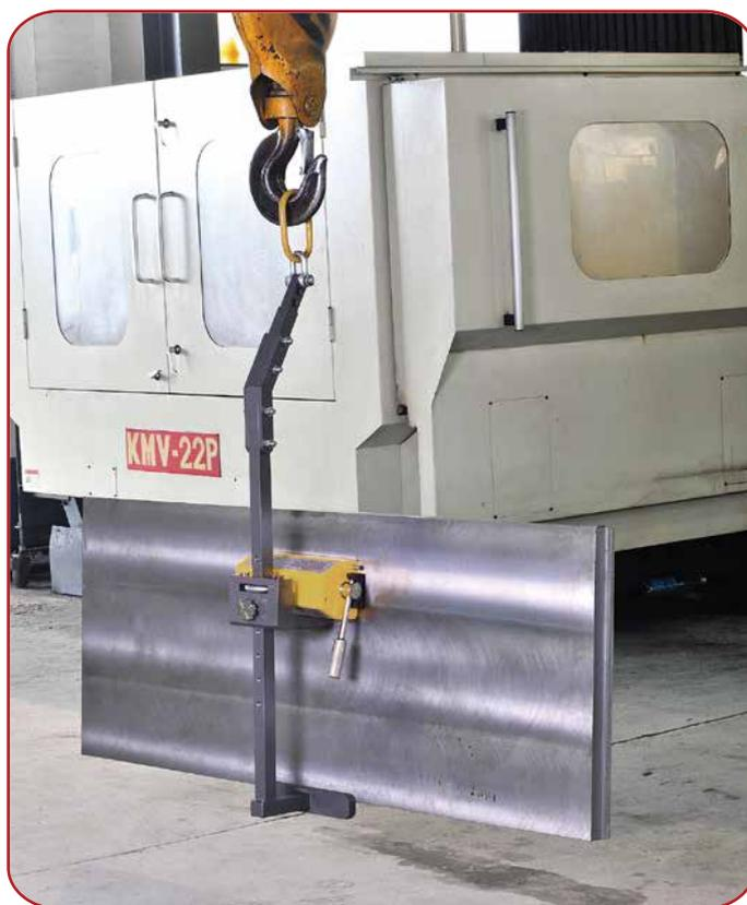
SOPH proporciona una línea de accesorios para los Levantadores SAFER y así incrementar la flexibilidad en el manejo de piezas horizontal y verticalmente.
